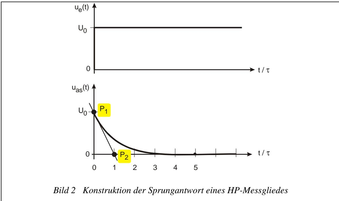
In Bild 3 sind alle Sprungantworten  $u_{as}(t)$  für die geforderten 4 Fälle  $\alpha$ ),  $\beta$ ),  $\gamma$ ) und  $\delta$ ) eingetragen. Die Punkte P1 liegen auf der Ordinate jeweils bei  $U_0 = 1$  V bzw. 2 V unabhängig von der Zeitkonstanten  $\tau_1$  bzw.  $\tau_2$ . Die Punkte P2 befinden sich auf der Abszisse bei  $\tau_1$  bzw.  $\tau_2$  unabhängig von der Sprunghöhe  $U_0$ .
