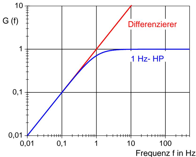
Bild 4 Amplitudengang von Differenzierer und RC-Hochpass
